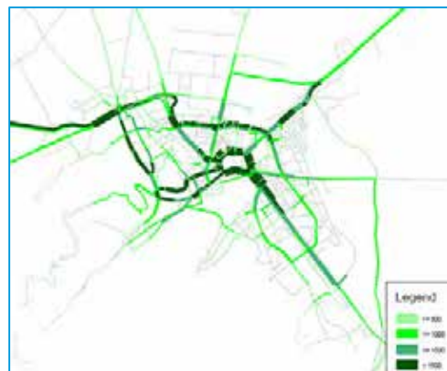
Figura 3.63 Fluxurile de circulație in anul 2030, ora de vârf de dimineața AM, aria municipiului Brasov (PCU / ora)
