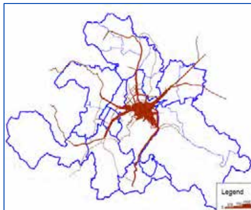
Figura 3.56 Fluxurile de circulație in anul 2020, ora de vârf de dimineața AM, aria Polului de Crestere Brasov (PCU / ora)
