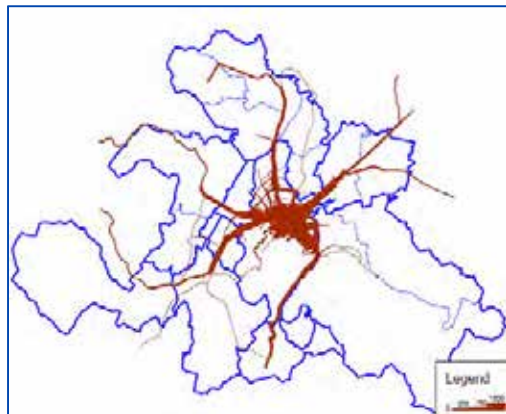
Figura 3.62 Fluxurile de circulație in anul 2030, ora de vârf de dimineața AM, aria Polului de Crestere Brasov (PCU / ora)
