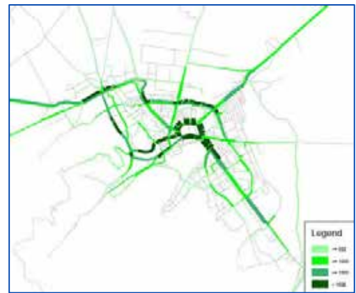
Figura 3.57 Fluxurile de circulație in anul 2020, ora de vârf de dimineața AM, aria municipiului Brasov (PCU / ora)
