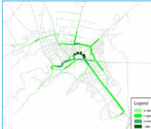
Figura 3.66 Fluxurile de circulație in anul 2030, ora de vârf de după amiaza PM, aria municipiului Brasov (PCU / ora)
